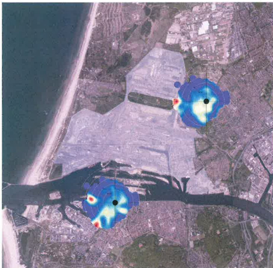
Figuur B1.6 CBPF-windanalyse voor het bodemstofprofiel. Achtergrond CBPF: Luchtfoto Actueel Ortho HR (Kadaster, www.pdok.nl , 2021) CC BY 4.0. Tata Steelterrein (IBIS, 2020)
