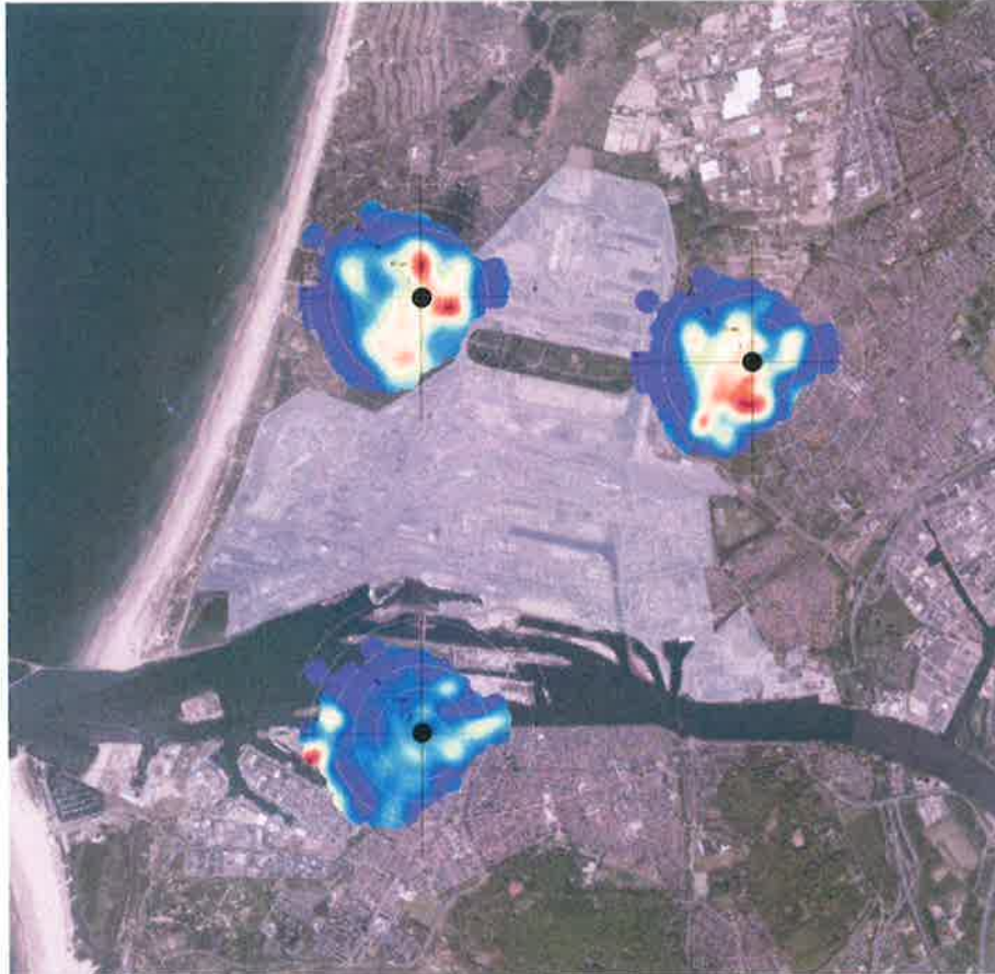
Figuur B1.2 CBPF-windanalyse voor het industrieprofiel. Achtergrond CBPF: Luchtfoto Actueel Ortho HR (Kadaster, www.pdok.nl , 2021) CC BY 4.0. Tata Steelterrein (IBIS, 2020)
